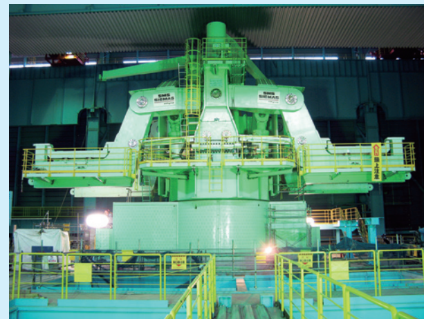
⑦ 総重量 400t のレードルターレット完成
